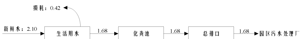
图 1 项目水平衡图
